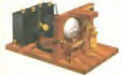
Первый радиоприёмник А. С. Попова
